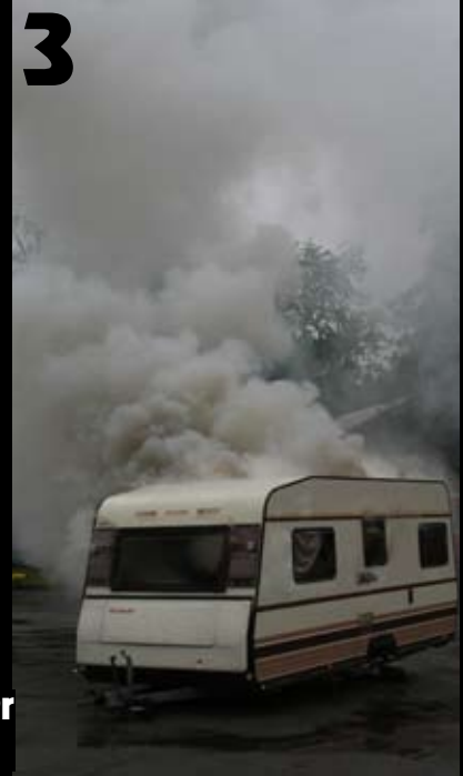
5. Vognen har nå brent i 4,5 minutter og er helt overtent. flammene har trengt gjennom aluminiumstak og vegger. Varmen er nå så intens at man må stå et godt stykke unna vognen.
