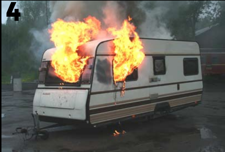
4. Det er nå gått 3 minutter siden papiret ble påtent. Vognens vinduer er smeltet og det kommer mengder med oksygen til og flammene blusser eksplosivt opp igjen.
