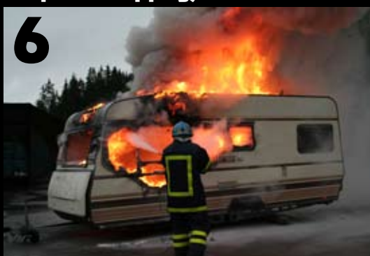
6. 6 minutter er gått og det er demonstrert forskjellig slukkeutstyr som pulver- og co2-apparat. Når flammene er så store som nå er det kun brannslangen til Oslo brannvesen som er kraftig nok til slukningsarbeidet.
