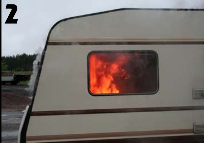
2. Etter 1 minutt har brannen allerede fått godt tak. Samtlige dører og vinduer er lukket.
